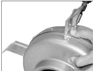
3. Skruva fast konsolerna med de självborrande skruvarna (förborrning behövs ej).
