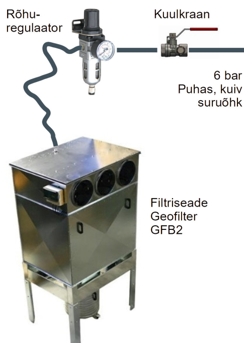
Põhimõtteline ühendusskeem Geofilter GFB2 ja rõhuregulaator
