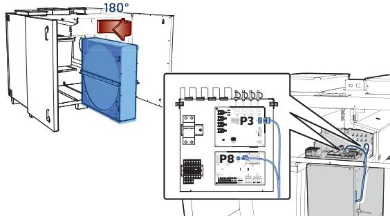
Står rotorn åt rätt håll och är inkopplad?
