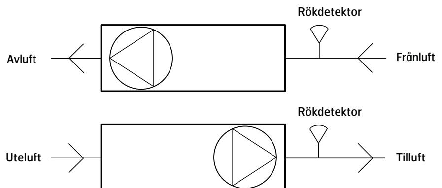
Schematisk diagram tillkoppling aggregat
