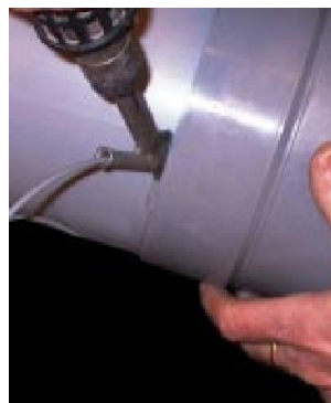
Pilt 1: Detailide ühendamine keevitusaparaadi abil
